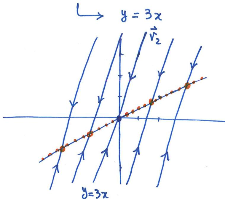
$$\vec{x}(t) = c_1 \vec{x}_1 + c_2 \vec{x}_2 = c_1 \begin{pmatrix} 2 \\ 1 \end{pmatrix} + c_2 \begin{pmatrix} 1 \\ 3 \end{pmatrix} e^{-5t}$$
